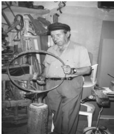
Ο βαρελάς υπολόγιζε ακτίνα, κύκλο και περίμετρο. Σήμερα μπορεί η τεχνική να απλοποιήθηκε, τα μηχανήματα να είναι καινούρια, τα βήματα ωστόσο στην κατασκευή του βαρελιού παραμένουν τα ίδια: -κόβεις το μπόι του βαρελιού από δρύινο ξύλο, το πλανιάζεις, το σκαρώνεις και του δίνεις την καμπύλη με τη φωτιά και το νερό. Μετά του περνάς τα στεφάνια.
